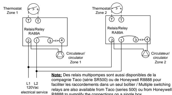
Figure 5 : Schéma de zonage par pompes multiples
