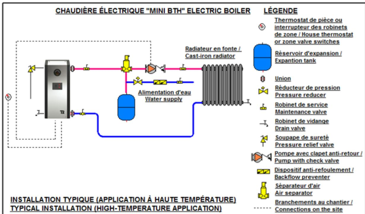
Figure 4 : Schéma d'installation pour applications à haute température
