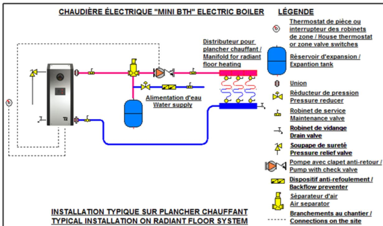
Figure 3 : Schéma d'installation sur plancher chauffant
