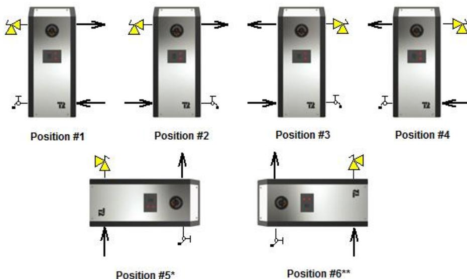
\*En position #5 : sur les chaudières MINI BTH 3 à 6kW l'élément localisé dans la partie supérieure de la chaudière devra être relocalisé dans l'ouverture de la partie inférieure.
